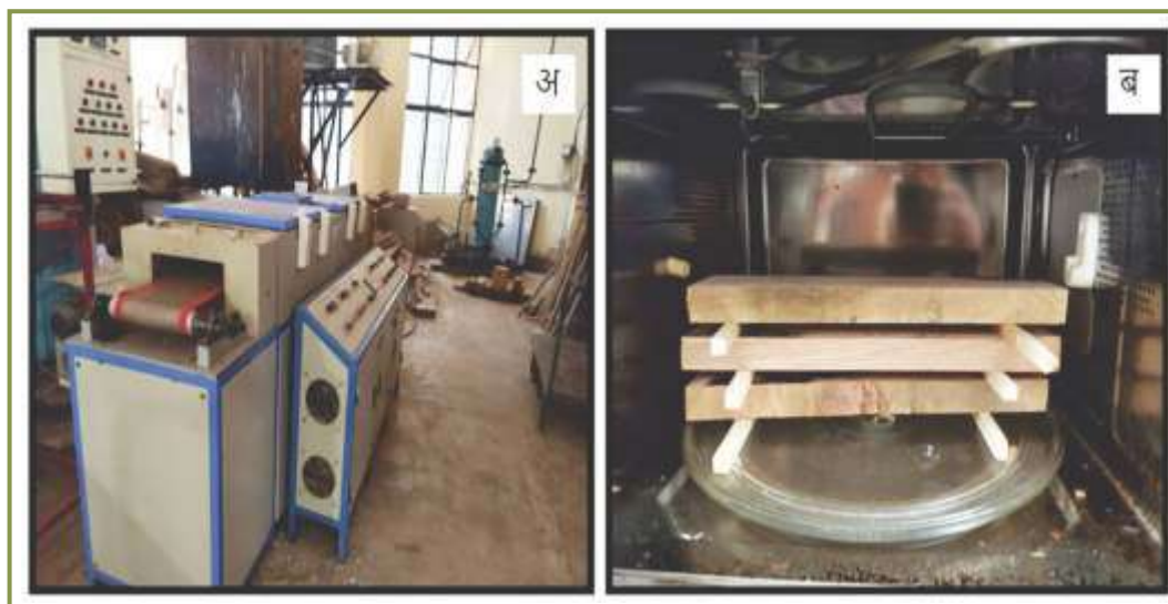
सूक्ष्म तरंग प्रणाली द्वारा सुखाने की मशीन अ) वाहक पट्टा प्रणाली ब) कक्ष प्रणाली
